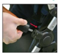
Pour attacher la barre frontale du siège, faire glisser les tiges en métal dans les trous situés de chaque côté du siège.
